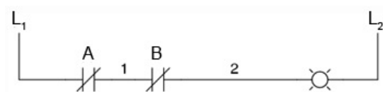
Figure 103: diagramă ladder; funcția logică SAU-negat
