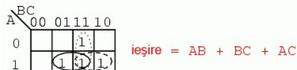
Figure 252: incinerator deșeuri toxice - simplificarea circuitului logic folosind hărți Karnaugh
