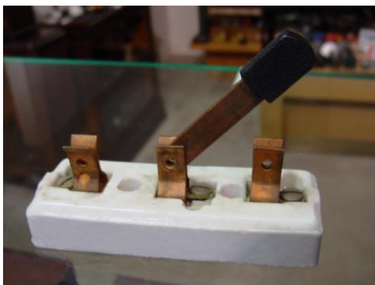
Figure 31: întrerupător tip cuțit cu două contacte
