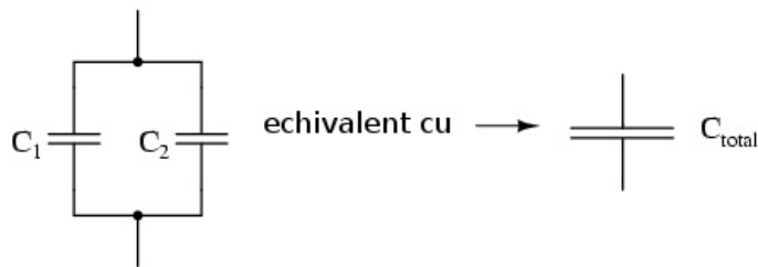
Figure 500: conectarea condensatorilor în paralel
