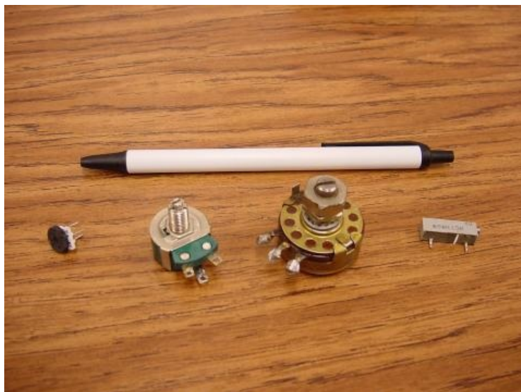
Figure 66: exemplu de potențiometre - rezistori variabili
