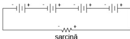
Figure 465: conectarea bateriilor în serie
