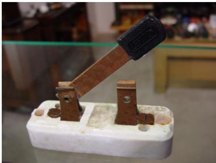
Figure 30: întrerupător tip cuțit cu un contact
