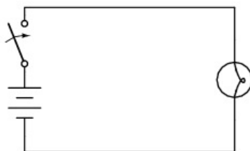
Figure 362: circuit electric simplu, format dintr-o baterie, o lampă și un întrerupător
