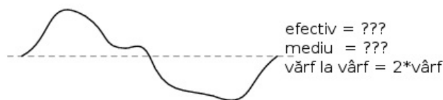
Figure 17: pentru o formă de undă distorsionată nu putem folosi aceiași coeficienți pentru calcularea relației dintre valorile de vârf, vârf la vârf, medii și efective
