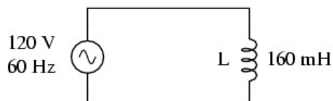
Figure 339: circuit electric monofazat de curent alternativ cu sarcină inductivă
