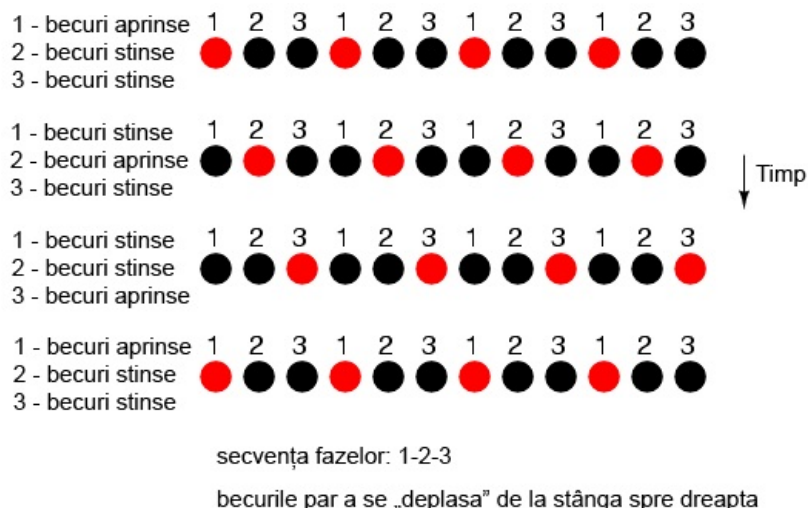
Figure 311: analogie pentru funcționarea motorului de curent alternativ trifazat; secvența fazelor unui set de becuri
