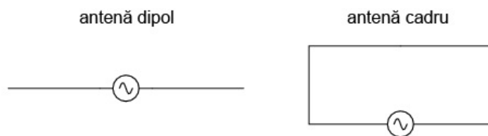
Figure 23: tipuri de antenă (dipol și cadru)
